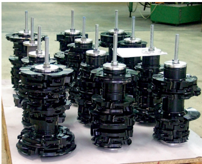
Fensterwerkzeuge von Aigner spindelgerecht vorbereitet für den Versand an Bayerwald.
